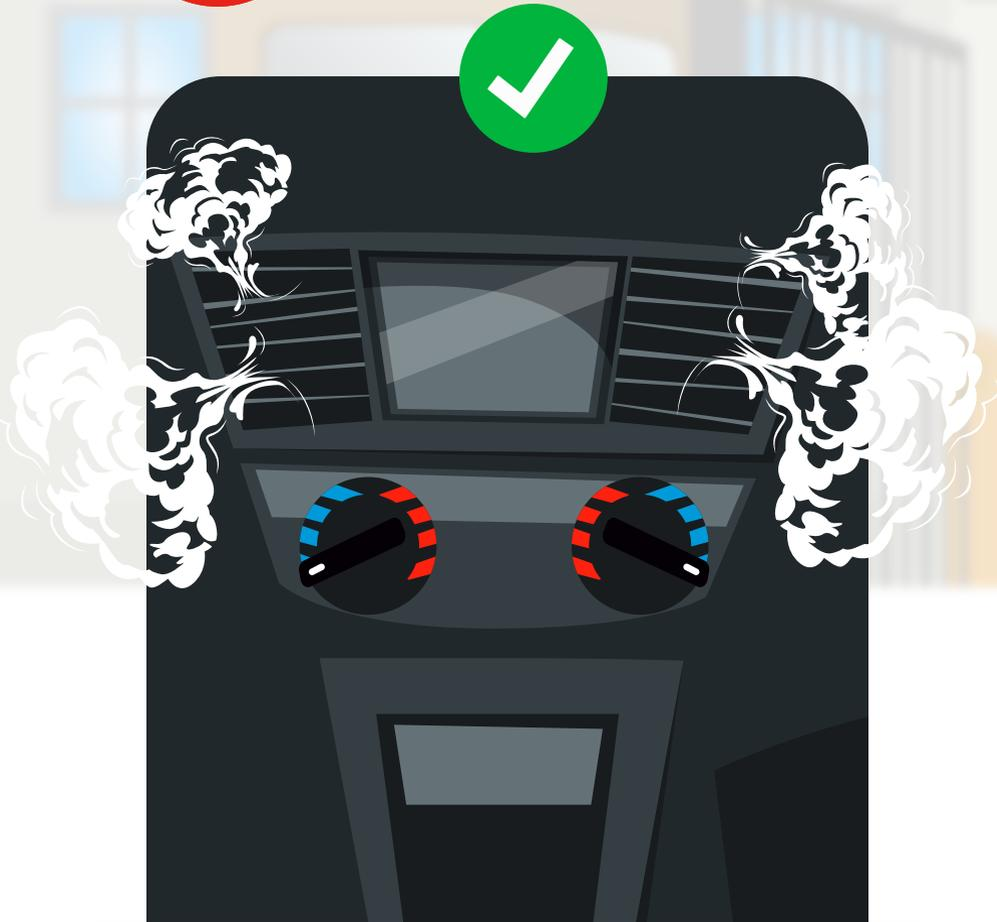
Ventilación dentro de la unidad (aire acondicionado con renovación continua de aire externo, apertura de compuerta superior)
