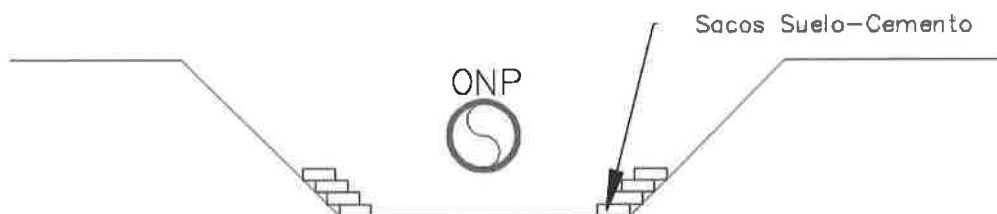
Gráfico N°1.20.- Detalle de Instalación de Sacos en Cuatro (4) Filas.
