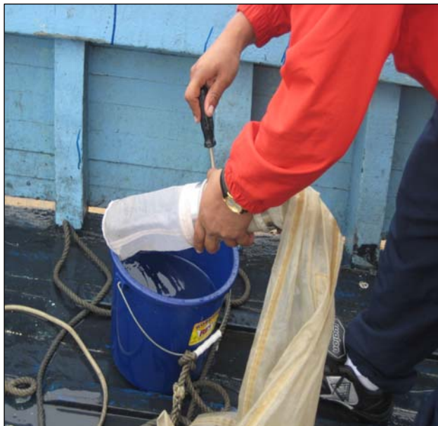
Foto 5 Las muestras fueron colectadas utilizando una red estándar de 50 cm. de diámetro de oca con un largo de 1.50 m de 300 micras de abertura de malla; incorporando un Flujómetro.
