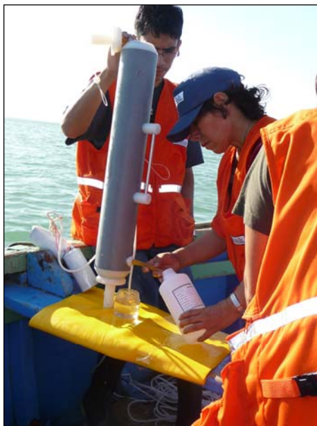
Foto 1 La transparencia del agua se midió mediante un disco Secchi; la temperatura mediante un termómetro oceanográfico; y el oxígeno disuelto (OD) mediante Titulación. El pH se determinó mediante potenciómetro portátil.
