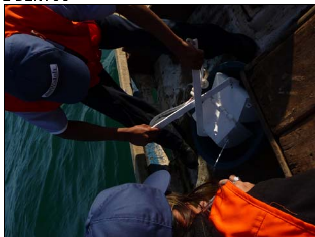
Foto 7 Las muestras de Bentos se extrajeron utilizando una draga Van Veen de 0.04 m 2 de área de barrido
