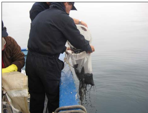
Foto 8 El material colectado se filtró en una bolsa tamiz de 500 micras.
