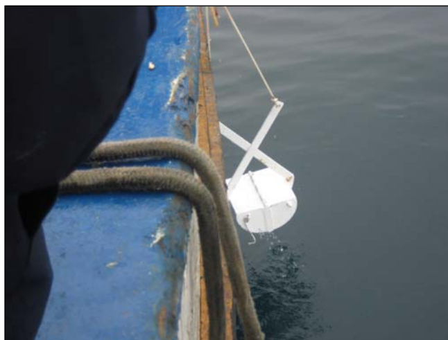
Foto 3 Se extrajeron muestras de sedimento de fondo superficial mediante una draga tipo Van Veen, de 0.04 m2 de área de barrido.
