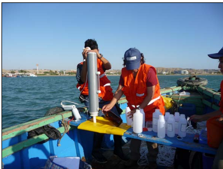
Foto 2 Para la evaluación de los otros parámetros como DBO, Sedimentos en suspensión, grasa, nutrientes, salinidad, etc., del nivel superficial u otros niveles de la columna de agua, mediante una botella Niskin.
