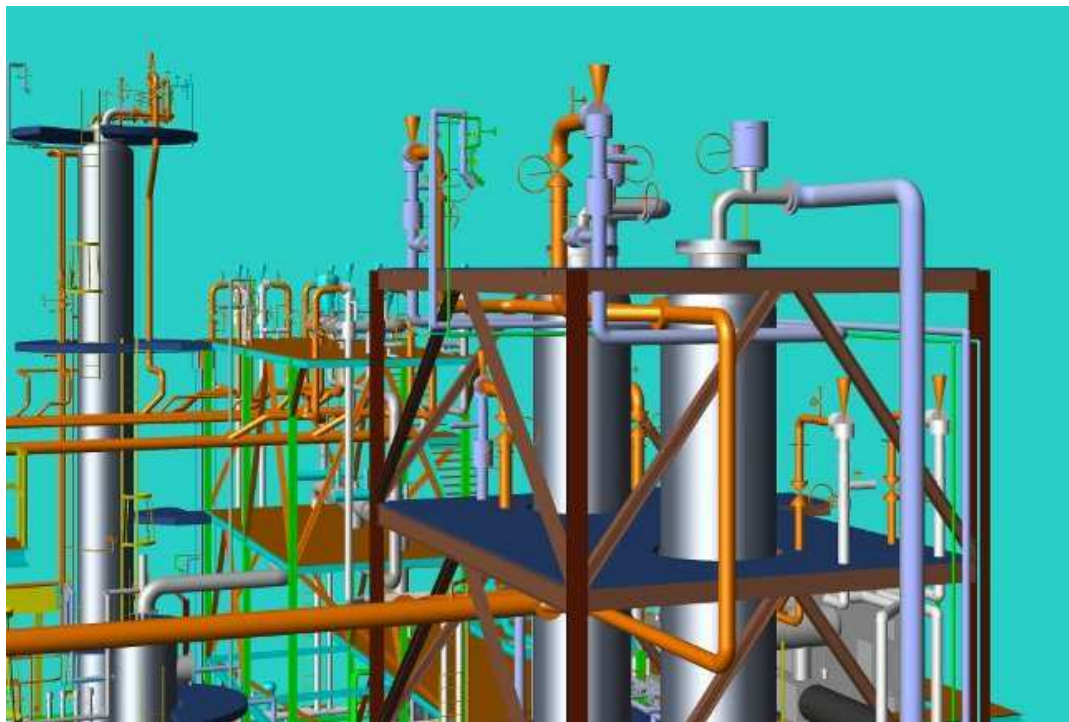
Figura Nº 24.1 Disposición de Tuberías Alrededor de Reactores
