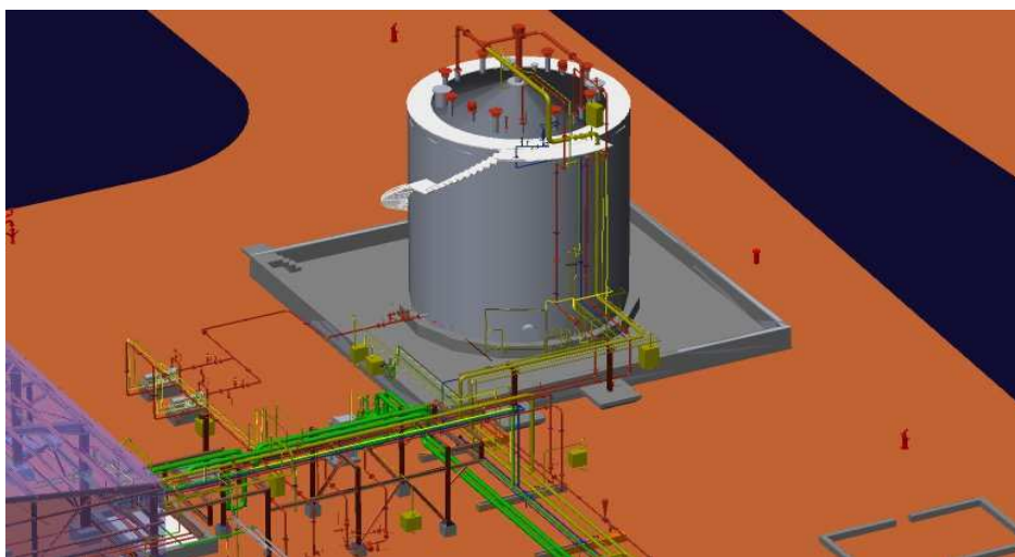
Figura Nº 32.1 Disposición de Tuberías Alrededor de Tanques
