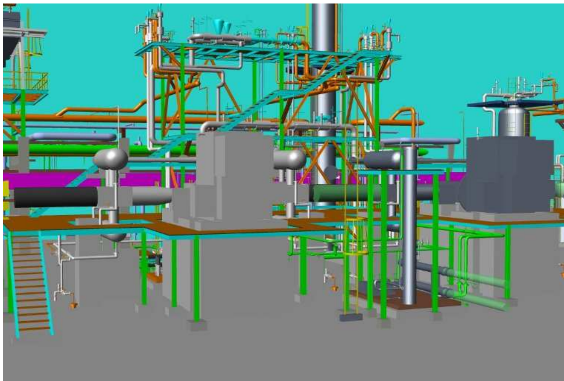
Figura Nº 20.4 Disposición de Tuberías Alrededor de Compresores Alternativos- Elevación
