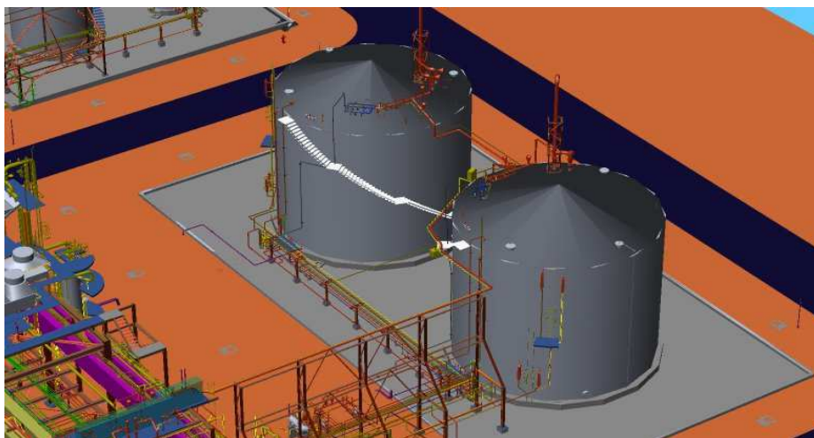
Fig. Nº 32.2 Disposición de Tuberías Alrededor de Tanques
