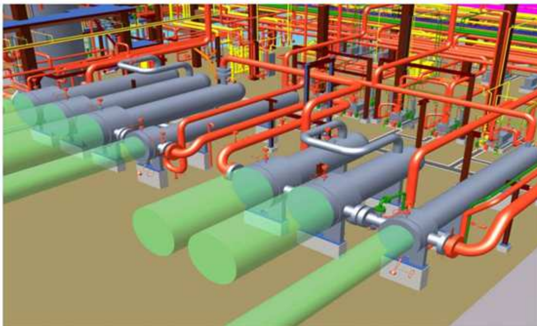
Figura N° 21.2 Disposición de Tuberías Alrededor de Intercambiadores de Alta Presión-Elevación
