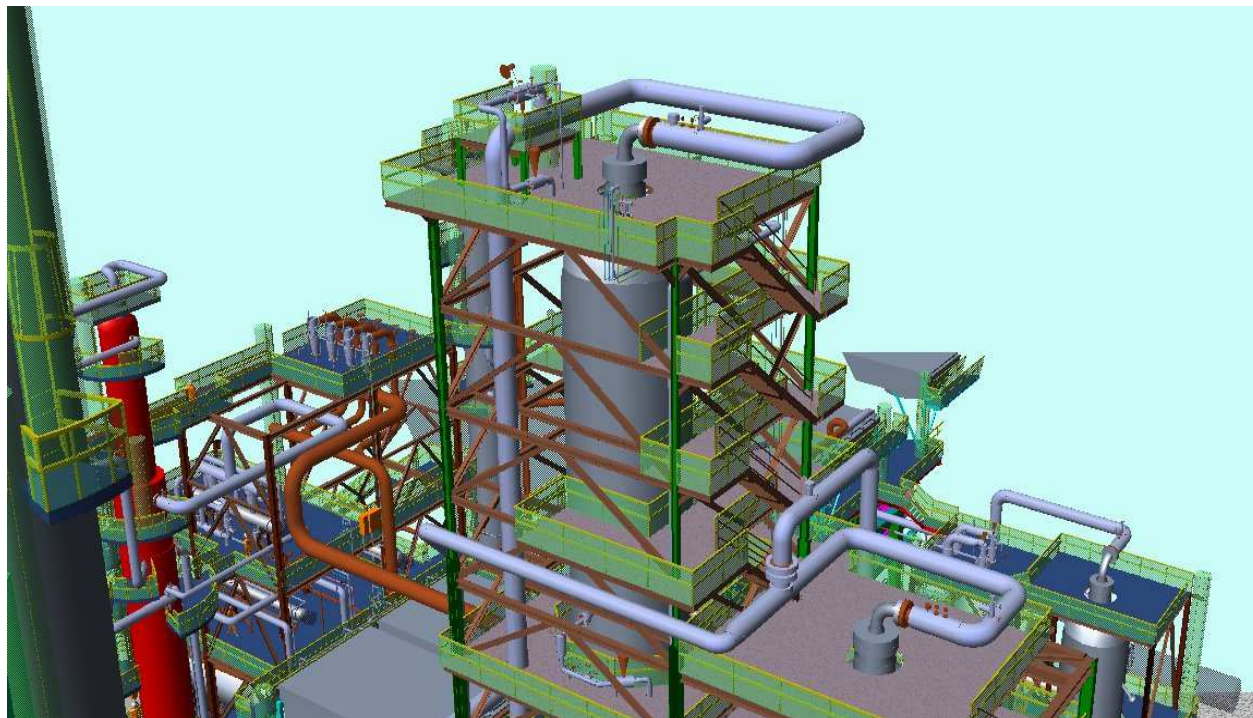
Figura Nº 24.3 Disposición de Tuberías Alrededor de Reactores
